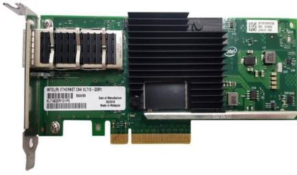
Adaptador de red convergente Intel Ethernet de un solo puerto 40 GbE QSFP+
