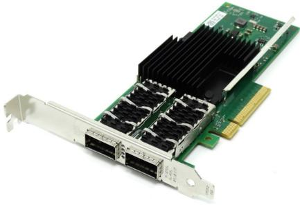
Adaptador de red convergente Intel XL710 de 40 GbE con doble puerto QSFP+ Ethernet
