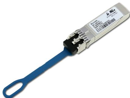
Transceptor óptico de longitud de onda larga Brocade XBR-000199 de 16 Gb: 16 Gbit/s, conectividad de hasta 10 km, paquete de 8 57-0000089-01
