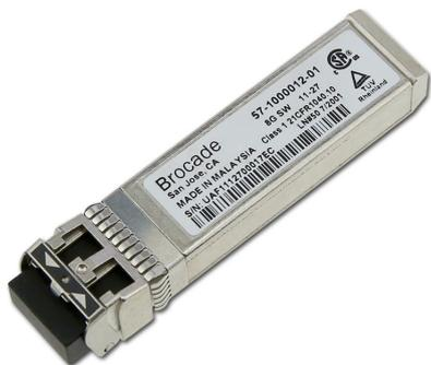
Transceptor óptico de longitud de onda corta Brocade XBR-000159 de 8 Gb: 8 Gbit/s, conectividad de hasta 500 m, paquete de 128 57-1000012-01
