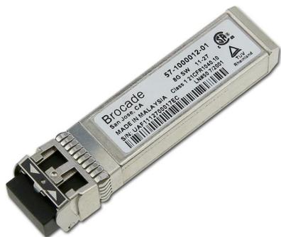
Transceptor óptico de longitud de onda corta Brocade XBR-000147 de 8 Gb: 8 Gbit/s, hasta 500 m de conectividad, 57-1000012-01
