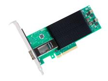
Adaptador de red convergente Intel X520 4x10GbE de un solo puerto QSFP+ Ethernet
