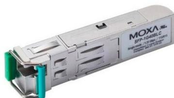
Moxa SFP-1G40BLC Módulo SFP tipo WDM (BiDi) con 1 puerto 1000BaseSFP con conector LC para transmisión de 40 km; TX 1550 nm, RX 1310 nm, temperatura de funcionamiento de 0 a 60 °C
