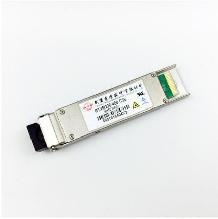
Transceptor óptico RTX226-480-C36 de WTD 10Gbps 1550nm los 80km XFP
