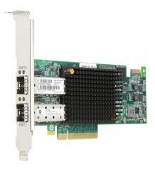
ADAPTADOR DE BUS HOST DE CANAL DE FIBRA PCIE DE 16 GB Y 2 PUERTOS HPE SN1000E, 676881-001 QR559A
