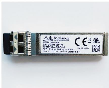
Módulo óptico Mellanox MFM1T02A-SR SFP+ para 10GBASE-SR
