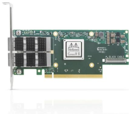
Tarjeta adaptadora Mellanox MCX653106A-EFAT ConnectX-6 VPI, 100 Gb/s (HDR100, EDR IB y 100 GbE), puerto dual QSFP56, PCIe3.0/4.0 Socket Direct 2x8 en una fila, soporte alto
