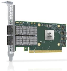
Tarjeta adaptadora Mellanox MCX623106AS-CDAT ConnectX-6 Dx EN, 100 GbE, puerto doble QSFP56, PCIe 4.0 x16, arranque seguro, sin cifrado, soporte alto
