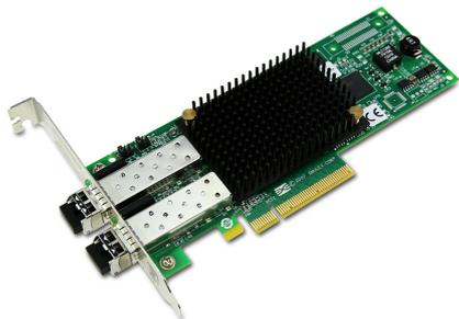
Adaptador de bus de host de dos puertos PCIe 2.0 de canal de fibra de 8 Gb Emulex LPe12002
