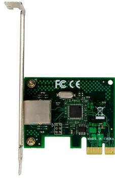
Adaptador de servidor Ethernet Intel I210 de un solo puerto RJ45, 10/100/1000, PCIe v2.1 (2,5 GT/s) x1
