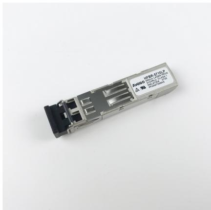
Avago 1.25Gbd 850nm 3.3V LC Módulo transceptor SFP dúplex enchufable
