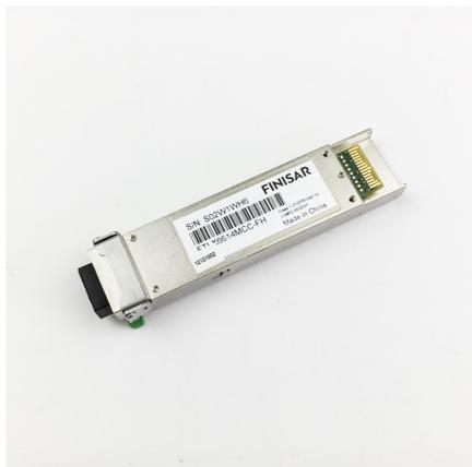
II-VI Finisar 10G Banda C Sintonizable 40km DWDM XFP Transceptor
