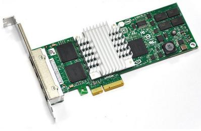
Adaptador de servidor Intel PRO/1000 PT de cuatro puertos, 4 RJ45, 10/100/1000, PCIe, 82571 GB
