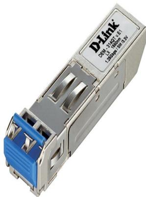
D-Link DEM-314GT 1000BASE-LX Transceptor SFP monomodo de 50 km
