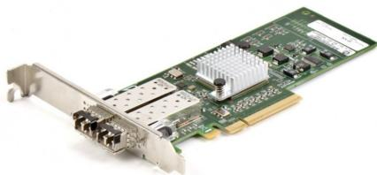
ADAPTADOR DE BUS HOST DE CANAL DE FIBRA PCIE HPE 82B DE 8 GB Y 2 PUERTOS, 571521-002
