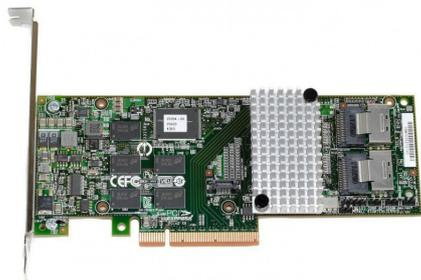
Tarjeta controladora RAID Broadcom 3ware 9750-8i LSI00214 PCIe 2.0 x8 de 8 puertos interna de 6 Gb/s SATA+SAS
