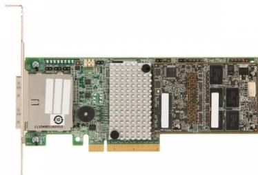
Controlador RAID Broadcom LSI 9286CV-8e LSI00333 de ocho puertos 6 Gb/s PCI Express 3.0 SATA+SAS con protección de caché flash CacheVault
