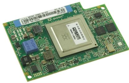
IBM 44X1945 44X1947, 44X1948 Tarjeta de expansión de canal de fibra de 8 Gbps de doble puerto de QLogic para BladeCenter
