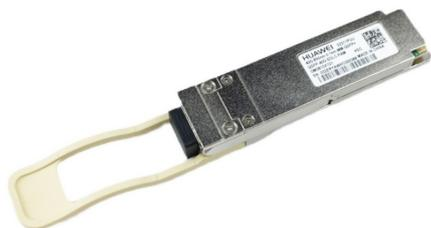
Transceptor óptico Huawei QSFP-40G-SDLC-PAM 40GBase-SDLC, QSFP+, 40G, módulo multimodo (850nm, PAM4, 0,1 km-OM3, 0,15 km-OM4, LC)
