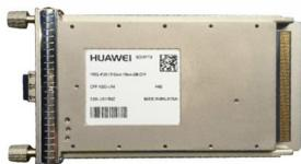
Transceptor de alta velocidad Huawei CFP-100G-LR4, CFP, 100G, módulo monomodo (banda de 1310nm, 4\*25G, 10km, LC recto)
