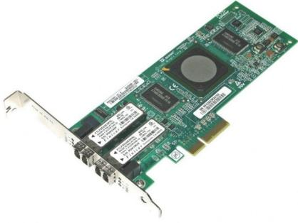
IBM 00Y3341 00Y3344 00Y3343 QLogic 16 Gb FC HBA de dos puertos para System x
