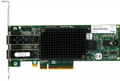
IBM 00JY848 00JY808 Emulex 8GB Adaptador HBA de perfil alto de fibra PCIE x4 de doble canal
